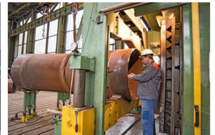
Jedes Bogenende wird maschinell bearbeitet und mit einer Schweißfase versehen. Die Geometrie muss stimmen, damit es auf der Baustelle beim Rundnahtschweißen der Bögen mit den Leitungsrohren keine Probleme gibt
